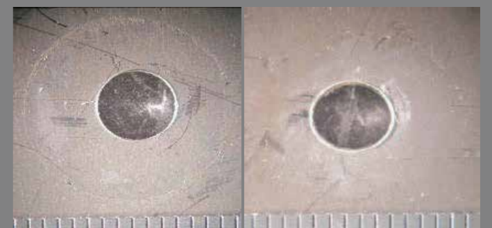
CPC kaplı paslanmaz çeliğin atmosferik maruziyeti için çatlak korozyonu örnekleri (sol - kontrol ve sağ - Cortec'in EcoLine 3690'i)
